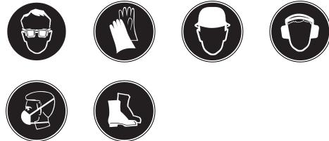
При работе с инструментом пользователь и находящиеся в непосредственной близости лица должны носить соответствующие защитные очки, защитный шлем, наушники, лёгкий респиратор или защитную обувь.
